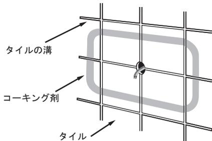
スピーカを取り付ける壁の表面に溝等がある場合は、この溝から壁裏への湿気の回り込みを防止するために、湿気防止ゴムの裏側をコーキングし、湿気止めをしてください。
