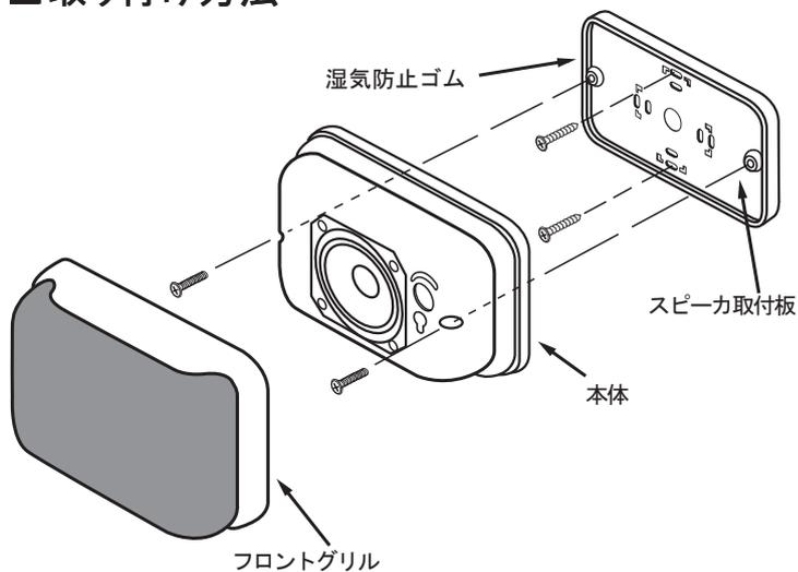
スピーカ取付板をネジで壁に取付けた後、本体を付属のネジで取付け、フロントグリルを付けてください。
