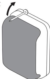
フロントグリルを取り外す時は、大きめの釘の頭を図の様にスピーカの凹部に入れてから、矢印の方向に釘をゆっくり引き上げて、取り外してください。
