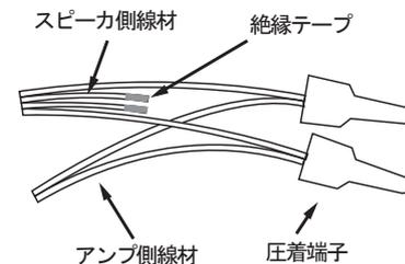
スピーカ側線材 (3.3KΩは橙線・5KΩは緑線・10KΩは黄線・COMは赤線)とアンプ側線材を圧着端子等で接続し、使用しない線材は必ず絶縁テープ等で絶縁してください。
