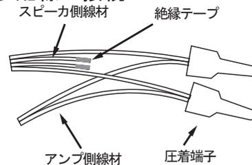
スピーカー 側線材 (3.3KΩは橙線・5KΩは緑線・10KΩは黄線・COMは赤線)とアンプ側線材を圧着端子等で接続し、使用しない線材は必ず絶縁テープ等で絶縁してください。
